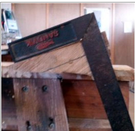
Fig. 26: Afsætning af kant
