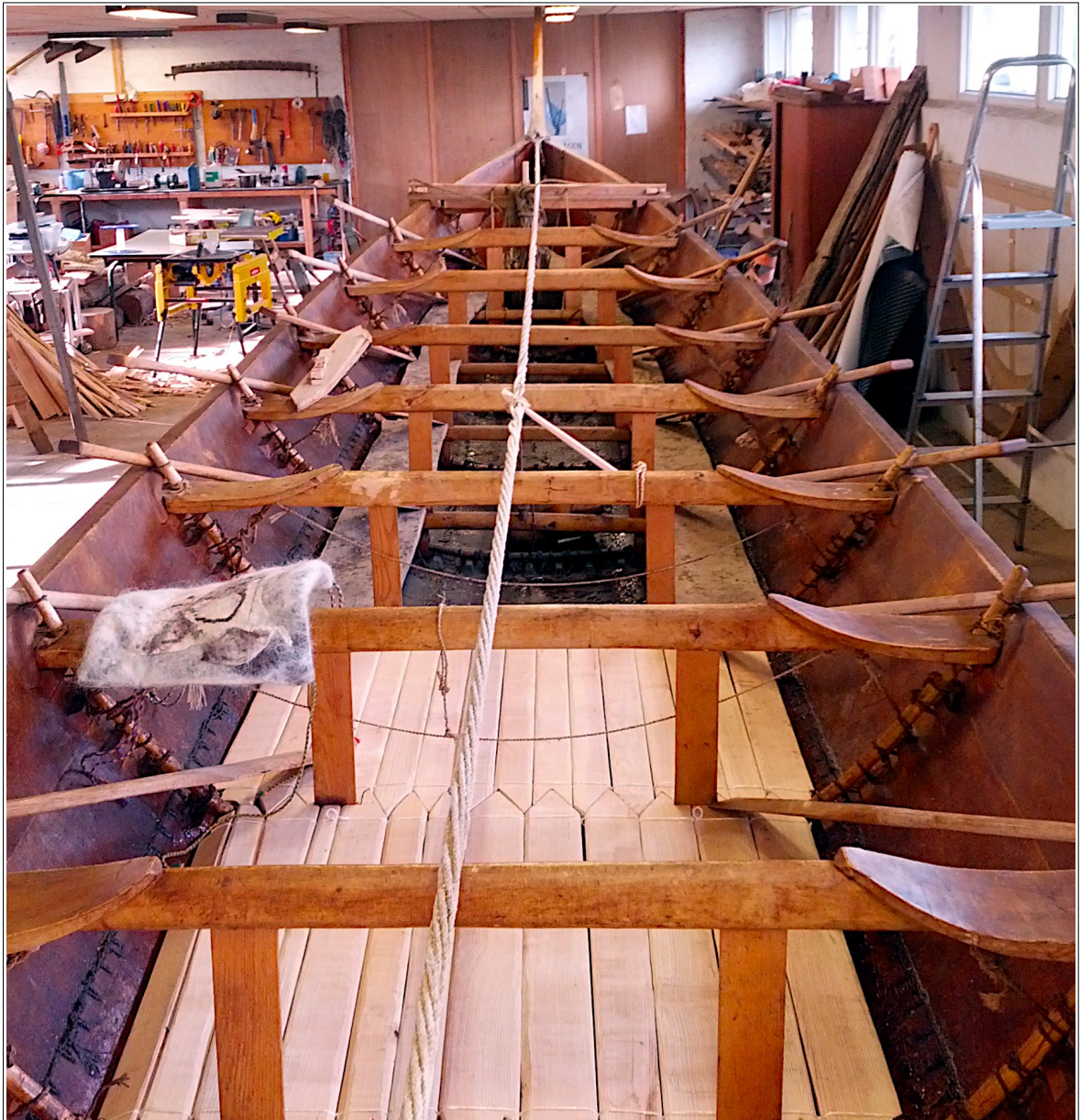
Fig. 17: Agterdækket er færdigt. Stadig det gamle fordæk.
