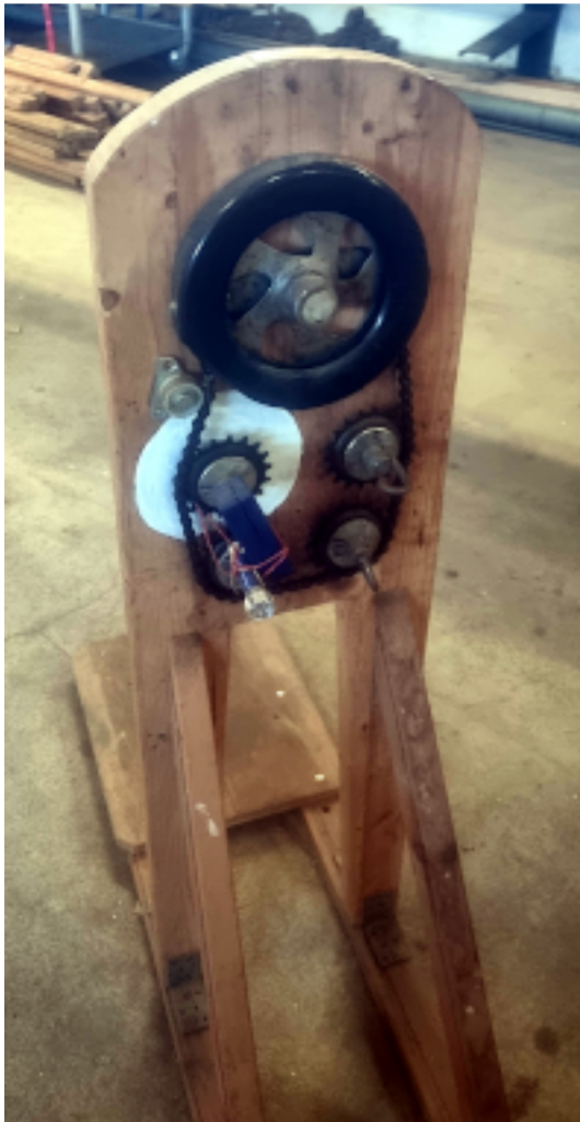
Figure 2: Krogsiden af geskæret. Der er anbragt en lille LED-lampe på kædehjulet med den hvide baggrund.
