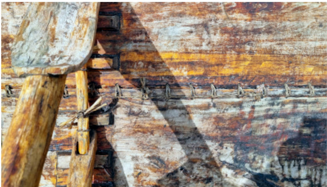
Fig. 13: Tjæren er næsten væk og sysnorene er meget tørre.
