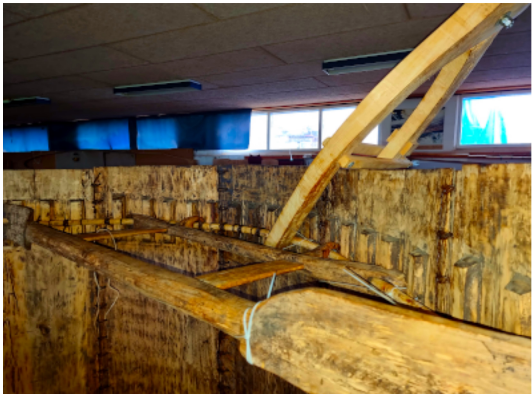
Fig. 7: Et ribbestativ bindes fast til klamperne.
