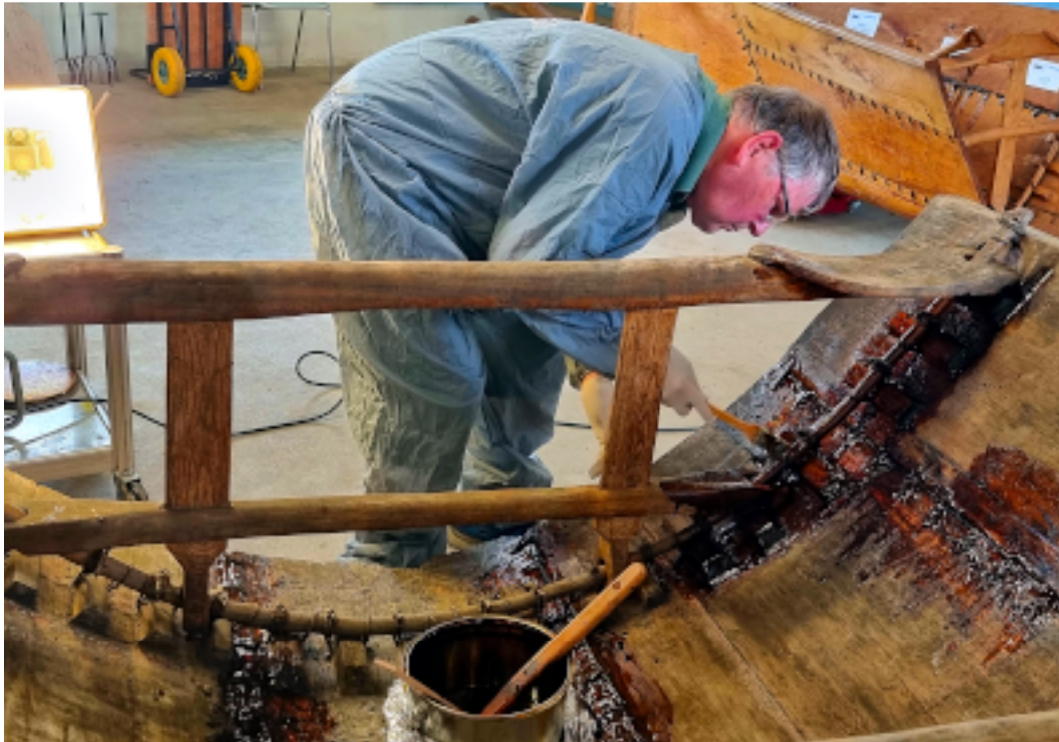
Fig. 15: John tjærer midterstykket indvendig.
