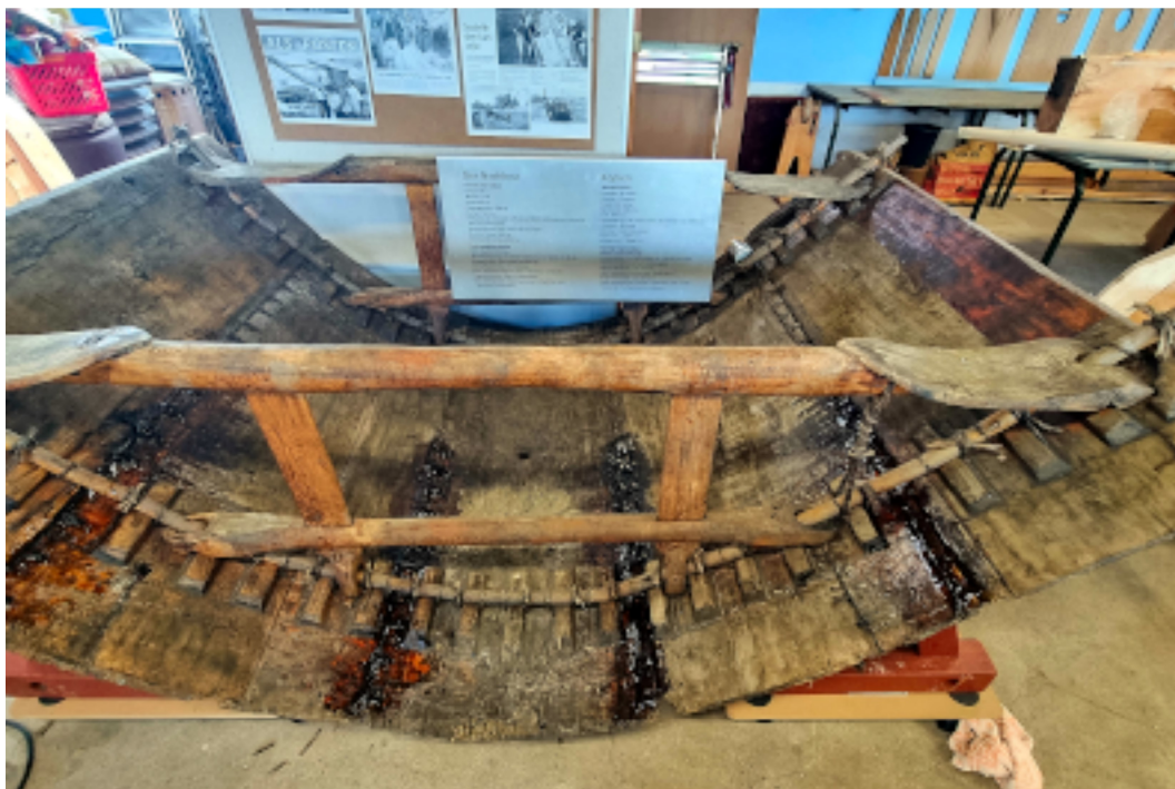
Fig. 14: Halvdelen af syningernes længde har fået harpiks.
