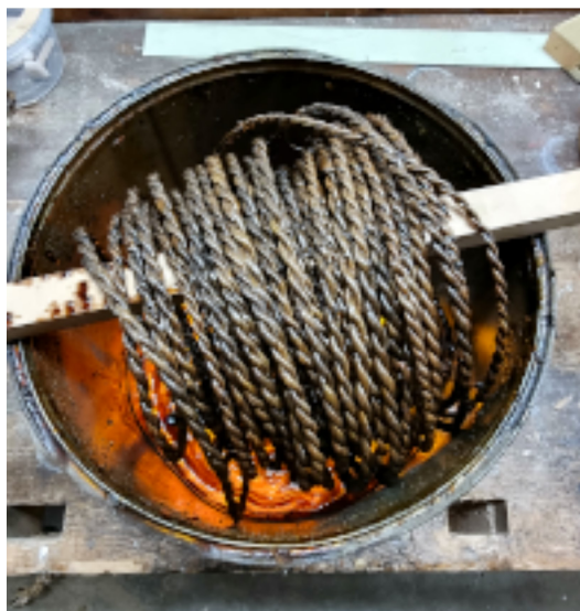
Fig. 4: Tjæret sysnor til afdrypning.
