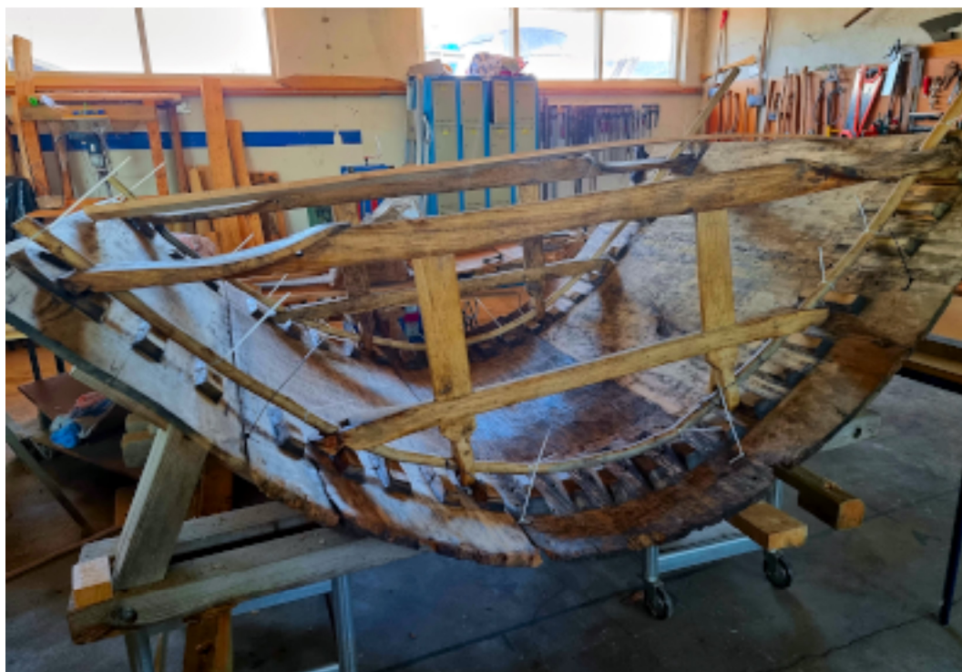
Fig. 5: Midterstykket holdt sammen med plaststrips.
