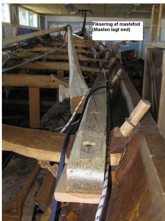
Fig. 4: Fiksering af mastefod - masten lagt ned.
