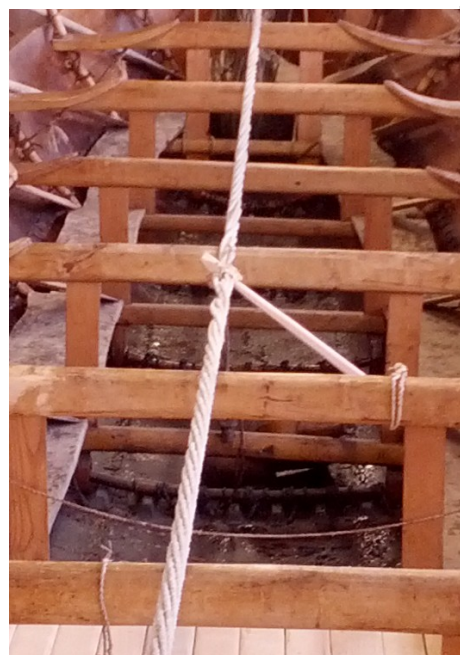
Fig. 7: Opstramning af spændtov.
