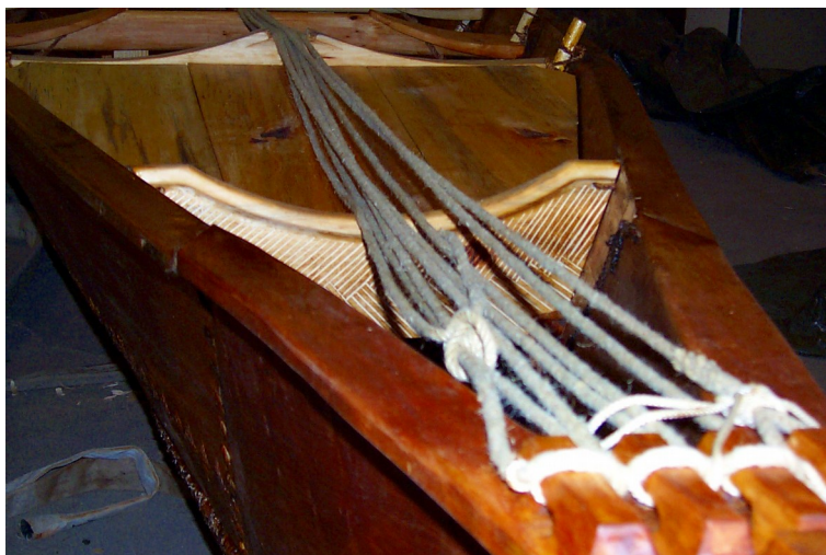
Fig. 6: Klamper og spændtov, agter.
