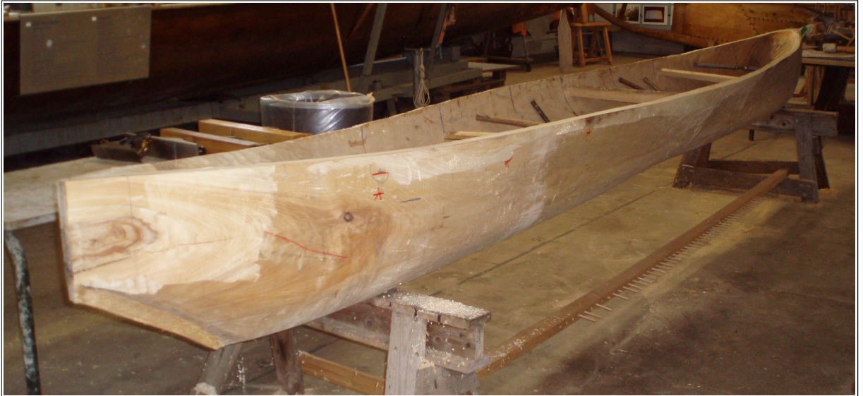
Fig. 8: Bundstykket som det ser ud august 2018 efter en vellykket udspænding.
