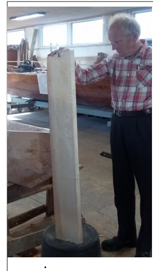
Fig. 8: Bundstykket som det ser ud august 2018 efter en vellykket udspænding.
