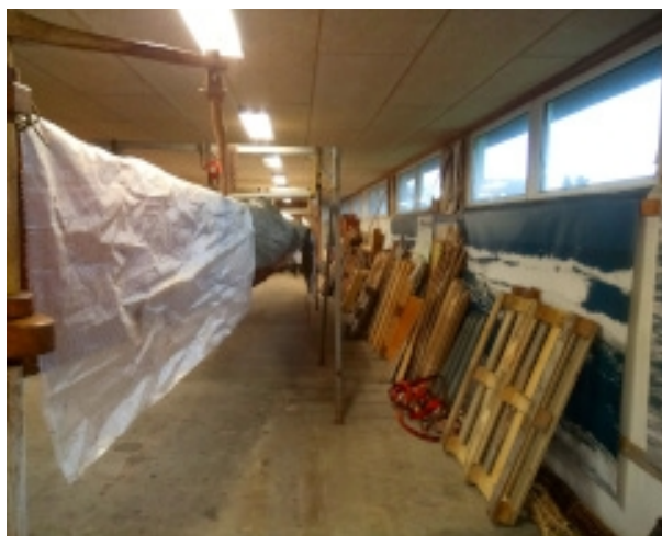
Tilia er ophængt i kranstativerne så højt som muligt, så vi kan komme til at behandle bunden. Pallerne til platformen er rejst op for at tørre.
