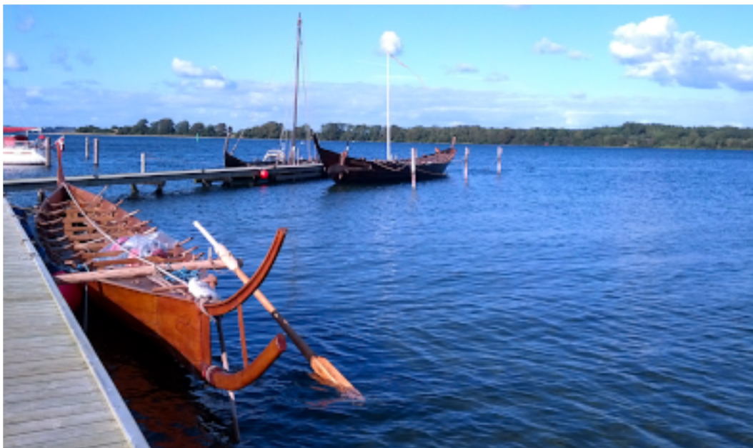
Billede 20: Et nyt ror, anbragt på en tværbom.
