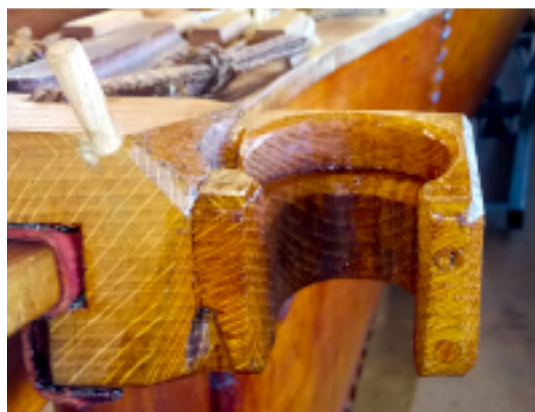
Billede 23: Øvre rorbeslag, set fra agter.
