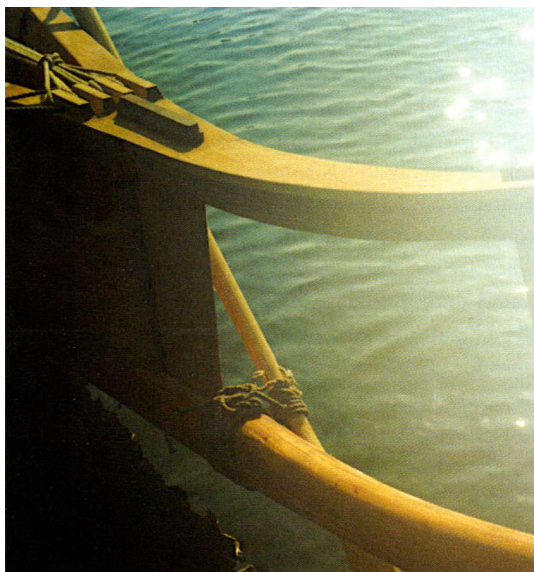
Billede 19: Roret fastgjort til det nederste agterhorn.
