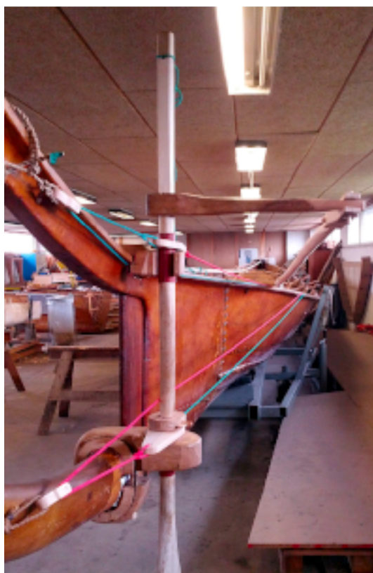
Billede 21: 1. udgave af rorplacering med rorløkker og snoretræk.
