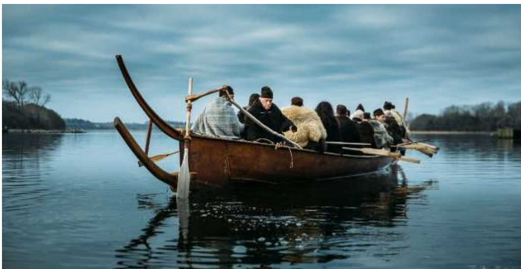
Billede 28: Ror hoppet ud af nedre rorleje.
