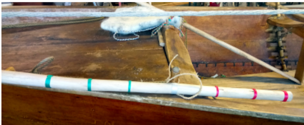
Billede 27: Rorudslagsmarkeringer, 15° interval, hvid: neutral, grøn: styrbord og rød: bagbord.
