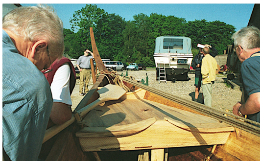
Billede 16: Roret bundet fast til ribbestativ nr. 1, styrbord svøb.
