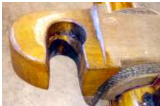
Billede 24: Nedre rorbeslag, set fra for.
