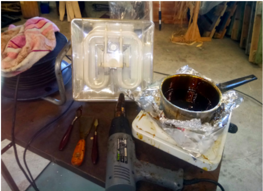
Fig. 14: Værktøj: Kabel, klud, lys, spartler, varmluftblæser og kogeplade med en gryde med harpiks.
