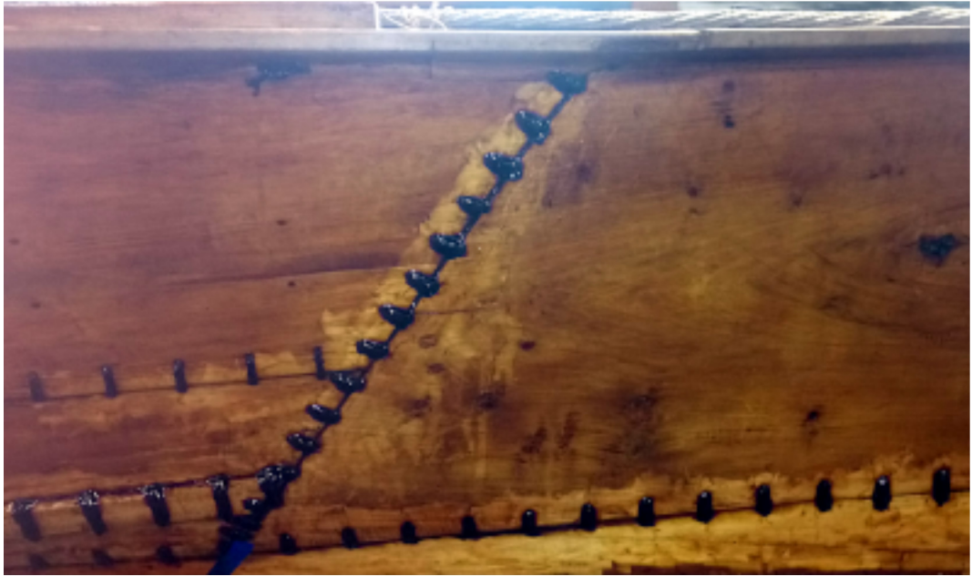
Fig. 20: Syningerne færdigbehandlet agter.
