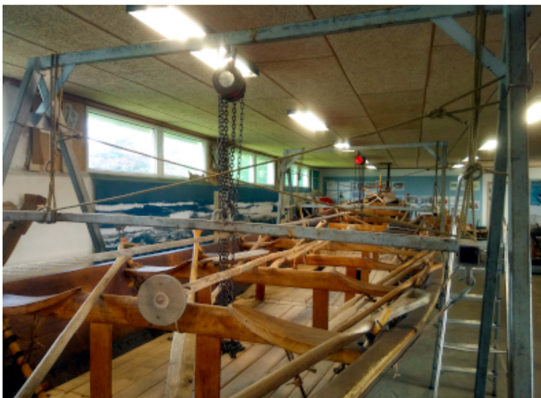
Fig. 12: Tilia ophængt i portalkranerne, med sikringer af båden.
