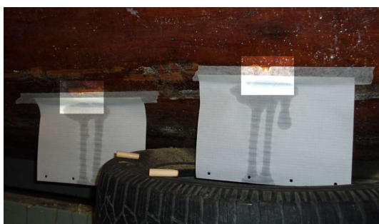
Fig. 16: Stophuller i båden og to propper (på dækket).
