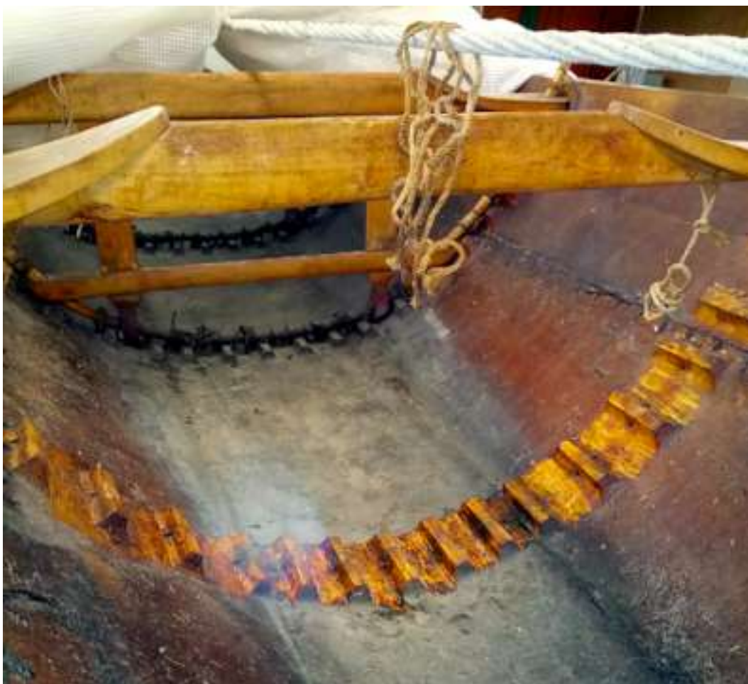
Fig. 4: Tofte 9's plads i Tilia, med afrensede klamper.
