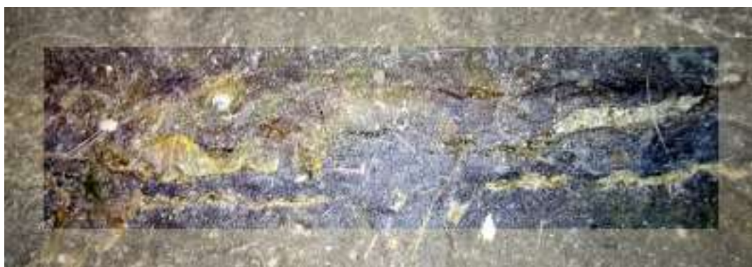
Fig. 3: Et eksempel med flere revner omkring en syning.
