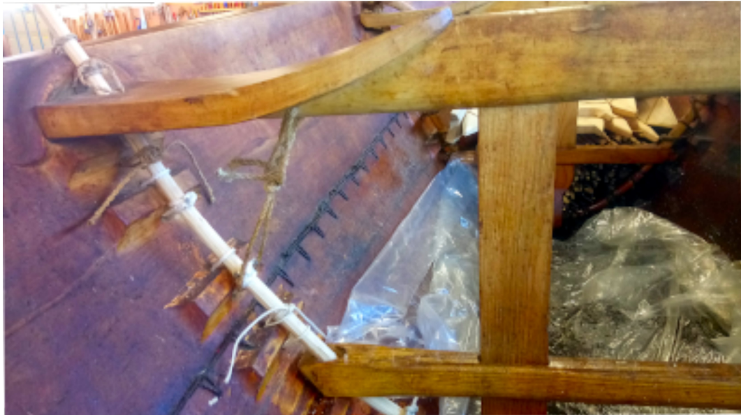
Fig. 5: Spant 9's ribbestativ isat med midlertidige surringer.
