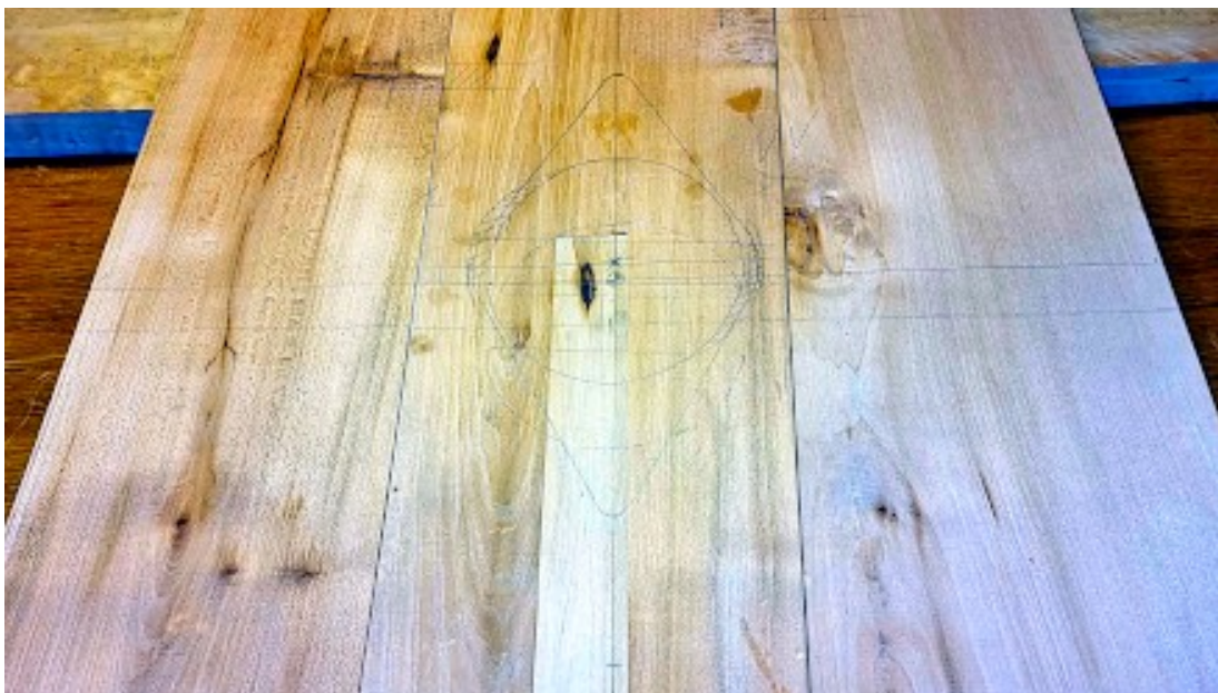
Illustration 12: Opmærkning af Skjoldbulens og grebhullets placering.
