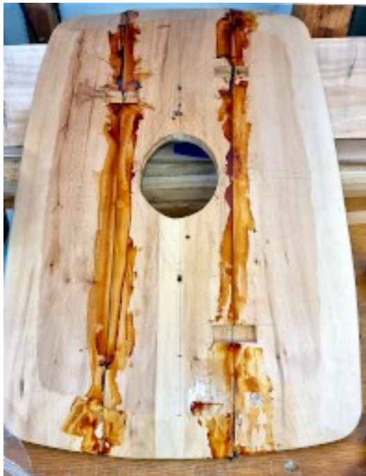
Illustration 14: Forsiden af den limede skjoldplade.
