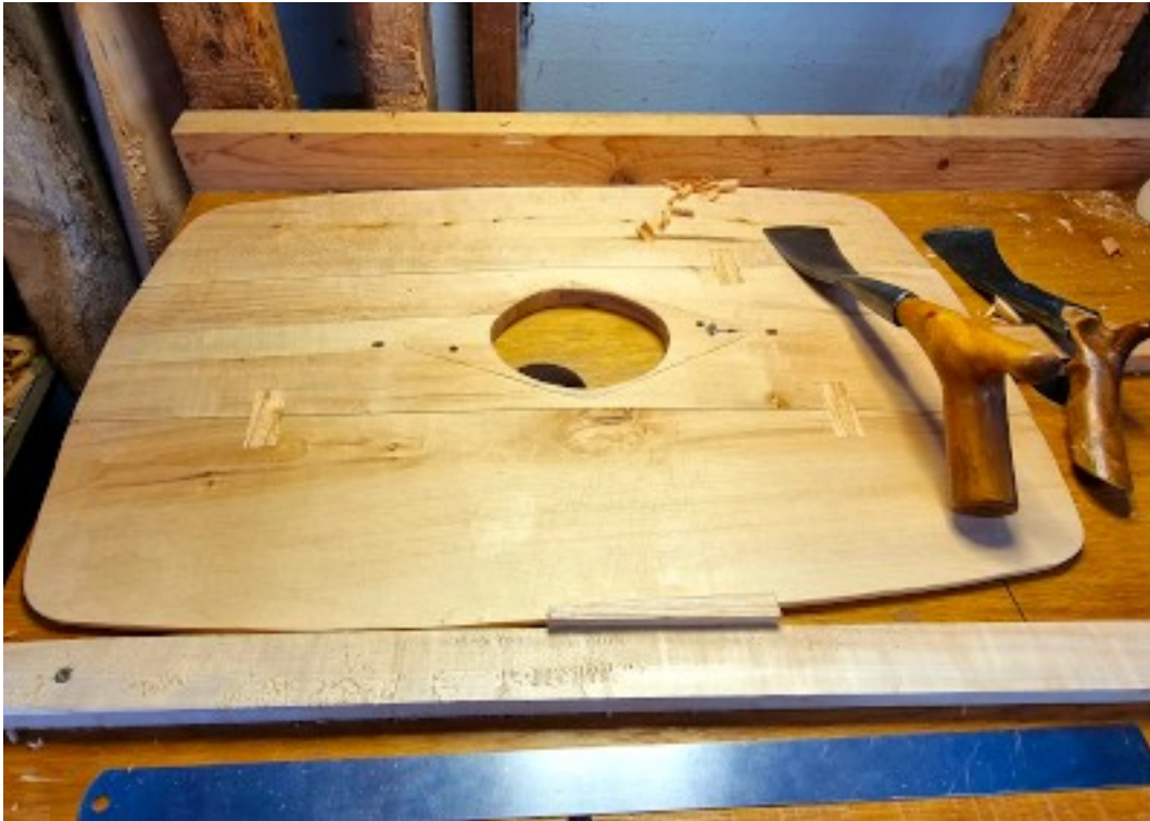
Illustration 16: Skjoldpladens forside færdigbearbejdet.
