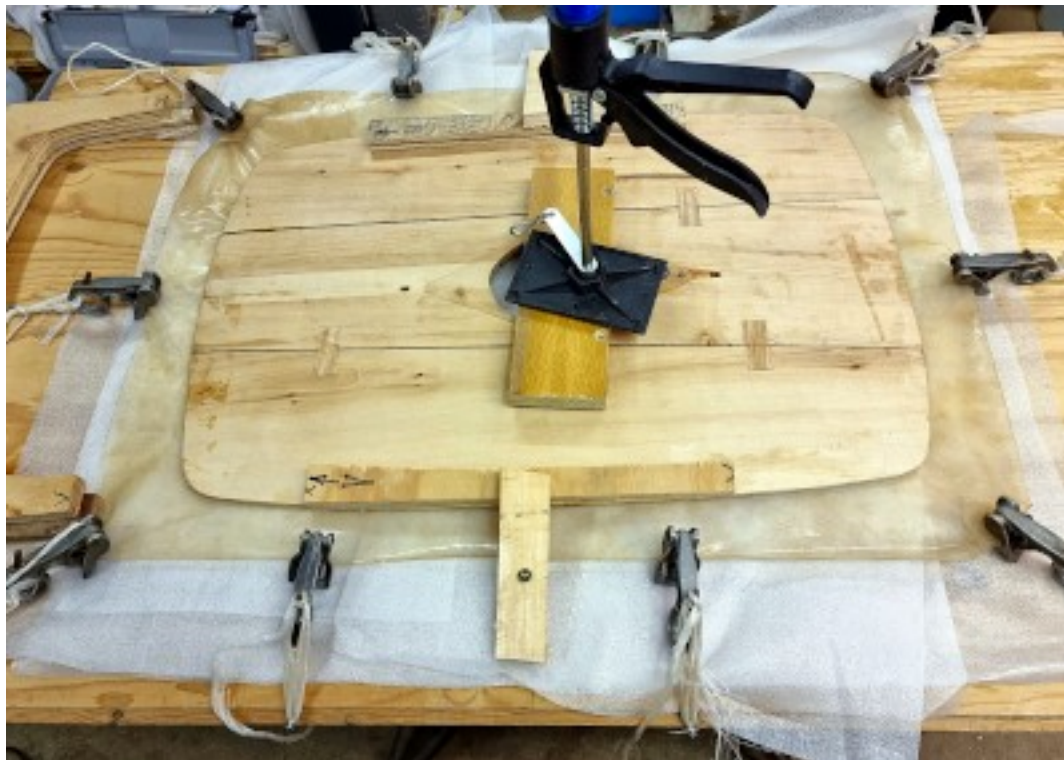
Illustration 19: Limning af skind på skjoldets bagside.
