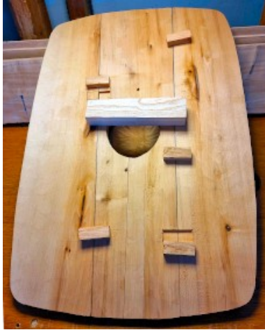
Illustration 13: Skjoldets bagside med nedstikninger til låsetappe. Tappene og ræmme til greb.
