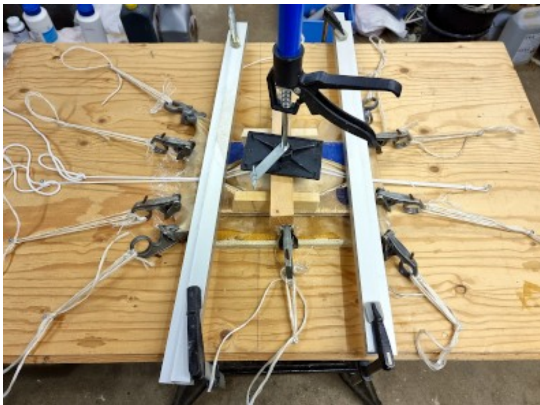
Illustration 18: Opspænding til formning af skjoldbulens skind.
