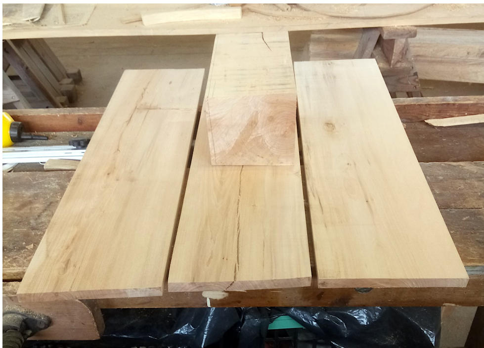
Illustration 9: Materiale til: Skjoldbule (øverst) og de tre skjoldplader. Bemærk at der er en revne i den midterste plade.
