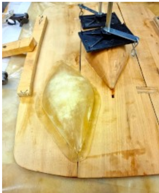
Illustration 20: Skjoldbullen limes fast på skjoldet. Bulens skind.
