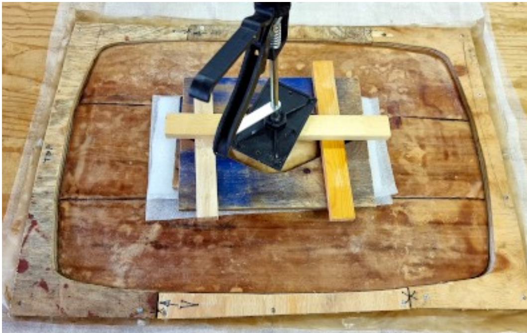
Illustration 21: Limning af skind på skjoldets forside.
